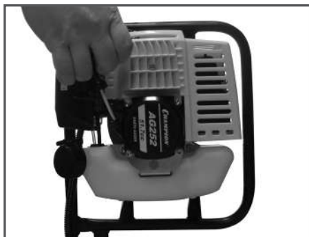
Рис. 7 Свободный ход шнура стартера
