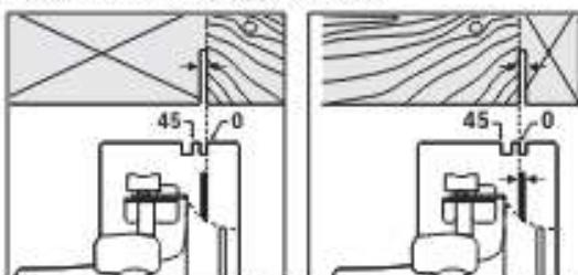
Метка линии распила 0° (11) показывает положение пильного диска при распиливании под прямым углом. Метка линии распила 45° (10) показывает положение пильного диска при распиливании под углом 45°.
