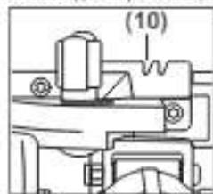
Используйте только метку угла пропила (10) при распиле под прямым углом и под углом 45° с направляющей шиной.
