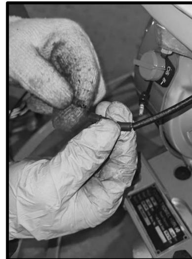
11. Пропустите трос управления скоростью через трубку под поручнем. Снимите воздушный фильтр и элемент воздушного фильтра с двигателя, ослабьте винт на регуляторе скорости, проденьте через провод регулятора скорости, как показано на рисунке, и снова затяните винт, чтобы зафиксировать провод регулятора скорости. Затем установите элемент воздушного фильтра и воздушный фильтр.
