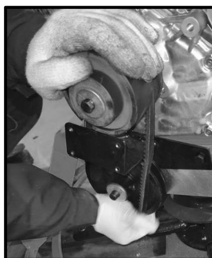
6. Установить защитный кожух ремня (6) на кронштейн и закрутить винты (7) используя шестигранный ключ.
