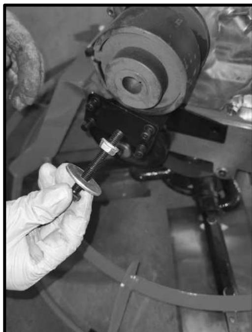
4. Закрепите обгонную муфту с помощью болта с шайбой и гайкой (3) идущих в комплекте, используя гаечный ключ. Если винт вращается вместе с коленчатым валом, вы можете потянуть трос ручного стартера двигателя другой рукой, чтобы закрепить его. После установки муфты снова затяните четыре гайки на основании двигателя.
