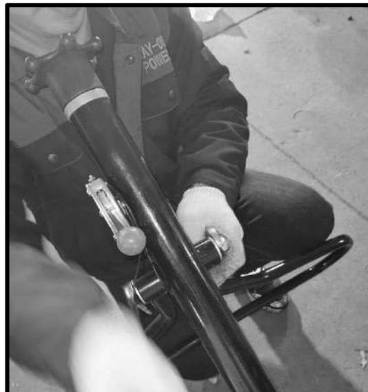
10. Раскрутите провод (11) рычага экстренной остановки машины (12) и проденьте его в направляющий канал стойки рукоятки управления, так чтобы конец провода вышел снизу направляющего канала. Отсоедините провод на двигателе и выключателе, затем подсоедините провод на поручне к проводу двигателя.
