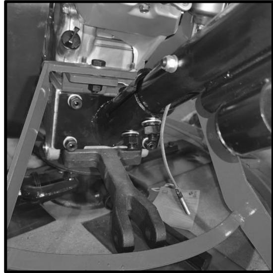
8. Подсоедините трос регулировки угла наклона лопастей к вилке. Предварительно установив в вилку штифт с отверстием (9) под шпильку троса. В данное отверстие штифта устанавливает саму шпильку троса (10) и снизу закручиваем гайкой. Натяните трос при помощи шпильки и гайки на конце троса. Регулировка угла наклона лопастей осуществляется с помощью барашкового винта находящегося на стойке рукоятки управления.
