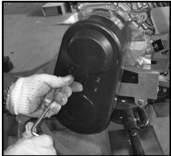
7. Открутить гайки (8) с кронштейна крепления рукоятки управления. Установить рукоятку управления на 4 шпильки кронштейна и закрутить гайки с шайбой и гравером (8) с помощью гаечного ключа.
