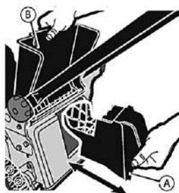
Рис. 3 Установка заглушки для мульчирования
