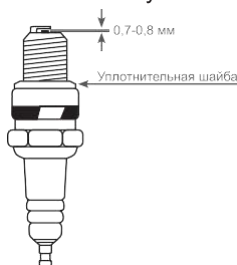
Рис. 17 Обслуживание свечи зажигания
