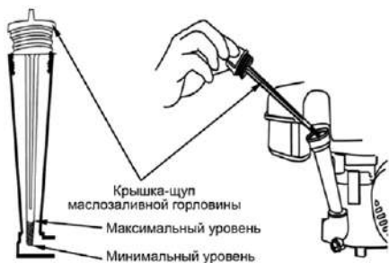
Рис. 7 Проверка уровня масла в картере
