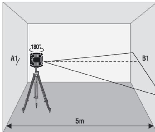
4. Поверните прибор вправо, измерьте вертикальное отклонение оси горизонтального луча от точки B1. Если отклонение превышает 2.5 мм – обратитесь в сервисный центр.
