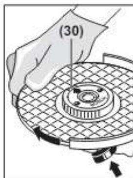
Для фиксации шлифовального шпинделя нажмите кнопку фиксации шпинделя (1). Чтобы затянуть быстрозажимную гайку, поверните шлифовальный круг с усилием по часовой стрелке.
