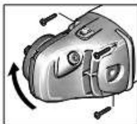
Редукторная головка может поворачиваться с интервалом в 90°. Таким образом выключатель может быть установлен в удобное для работы положение, например, для отрезных работ с вытяжным коллаком и направляющими салазками (21) или для левши.
