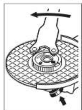
Должным образом затянутую, исправную быстрозажимную гайку можно открутить поворотом кольца с накаткой от руки против часовой стрелки. **Никогда не применяйте для откручивания заклинившей быстрозажимной гайки клещи, обязательно используйте рожковый ключ под два отверстия.** Накладывайте рожковый ключ под два
