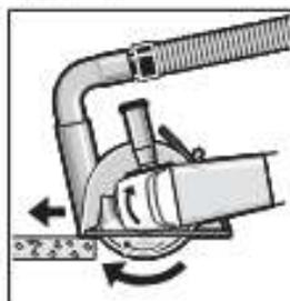
При обработке особо твердых материалов, например, бетона с высоким содержанием гравия, алмазный отрезной круг может перегреться и по этой причине повредиться. Вращающийся с алмазным отрезным кругом венец из искр однозначно указывает на такую ситуацию.
