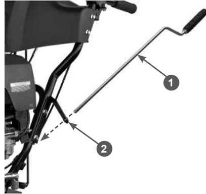
Рис. 26 Установка рычага управления поворотом жёлоба
