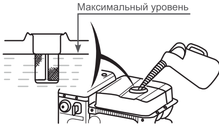
Рис. 31 Максимальный уровень топлива в топливном баке
