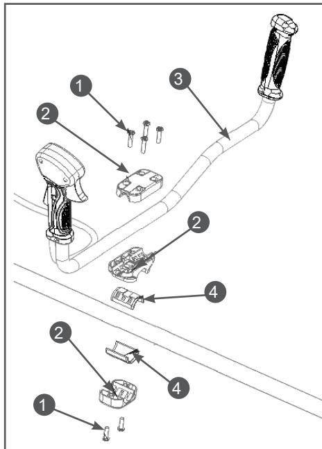
**Рис. 8 Установка рукоятки**
