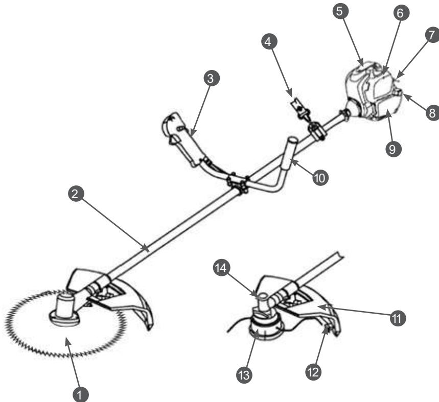
**Рис. 1 Основные узлы и органы управления триммера**
