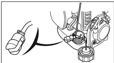
**Рис. 15 Топливный фильтр**
