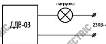
Рисунок 8. Схема подключения датчика движения ДДВ-03
