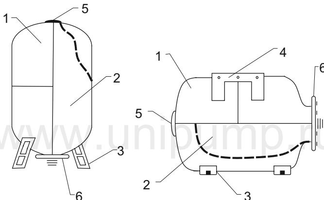
под давлением некоторый запас воды. При использовании совместно с реле давления, позволяет создать автоматическую станцию на базе погружного или поверхностного насоса. Гидроаккумулятор состоит из стальной емкости (бака) – (1), внутри которой находится резиновая мембрана (2). Внутренняя полость мембранны соединена с напорной магистралью через фланец (6), а в полость между
