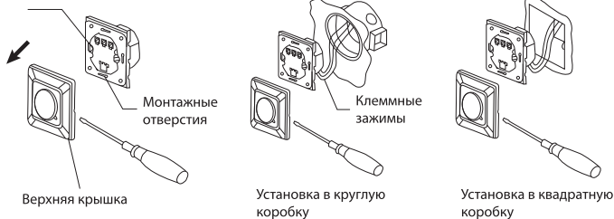
Рисунок 10. Схема монтажа датчика ДДМ-05В
