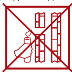
недостаточная тяга (Не используйте котел!)
