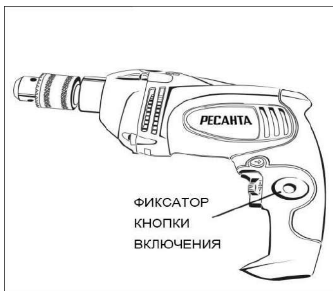
Рис. 8. Фиксатор кнопки включения
