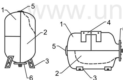
Гидроаккумулятор состоит из стальной емкости (бака) – (1), внутри которой находится резиновая мембрана (2). Внутренняя полость мембранны соединена с напорной магистралью через фланец (6), а в полости между внешней поверхностью мембранны и внутренней поверхностью емкости под давлением закачан воздух.
