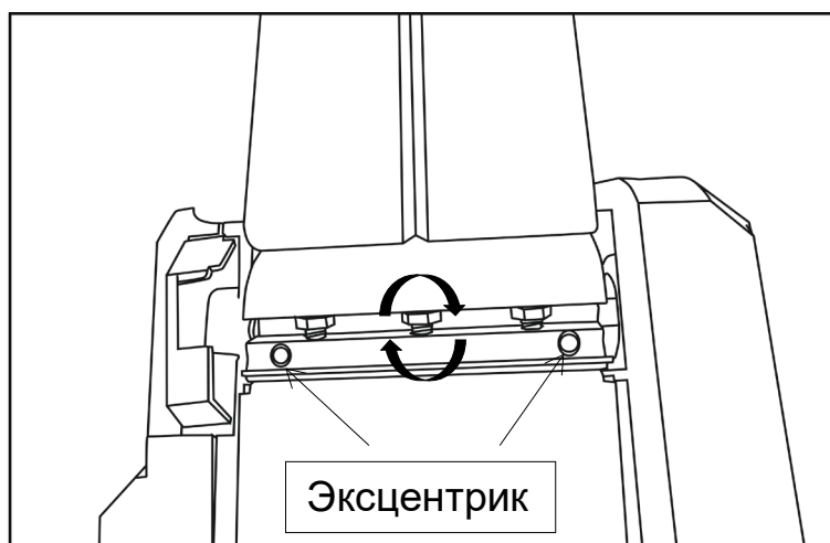
Рис.3. Замена режущего ножа
