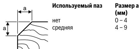
**Строгание с параллельным/угловым упором (см. рисунки F – H)**
