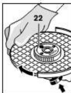
Для фиксирования шлифовального шпинделя нажмите кнопку фиксирования шпинделя **1**. Для затягивания быстрозажимной гайки поверните шлифовальный круг с усилием по часовой стрелке.
