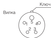
Рис. 5. Возможная схема подключения контактов на вилку (ВНР-9.000, ВНР-15.000)
