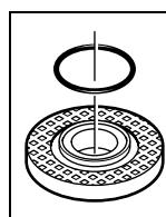
**Посадочный фланец для шпинделя M 14:** В посадочный фланец **9** вставлена вокруг буртика центрирования пластмассовая деталь (круглое кольцо). Если кольцо отсутствует или повреждено, то его следует
