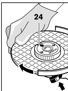
Для фиксирования шлифовального шпинделя нажмите кнопку фиксирования шпинделя **1**. Для затягивания быстрозажимной гайки поверните шлифовальный круг с усилием по часовой стрелке.
