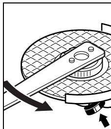
Правильно закрепленную, не имеющую повреждений быстрозажимную гайку Вы можете отвернуть, вращая рукой кольцо с накаткой против часовой стрелки.
