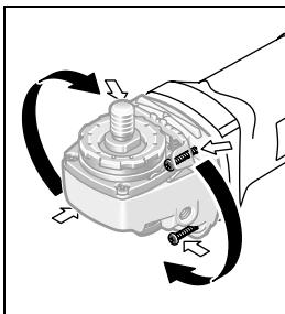
Вы можете повернуть редукторную головку шагами в 90°. Этим выключатель может быть поставлен в удобное для работы положение, например, для левши.
