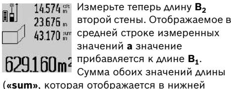
Измерьте теперь длину **B<sub>2</sub>** второй стены. Отображаемое в средней строке измеренных значений **a** значение прибавляется к длине **B<sub>1</sub>**.
