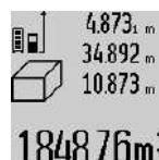
По окончании третьего измерения объем автоматически рассчитывается и высвечивается в строке результата **c**. Отдельные измеренные значения отображаются в строках измеренных значений **a**.
