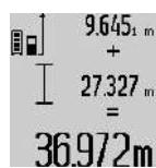
Для отрашивания суммы обоих измерений нажмите кнопку результата **6**. Расчет суммы отображается в строках измеренных значений **a**, сумма отображается в строке результата **c**.
