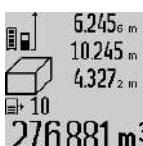
Чтобы вызвать сохраненные в памяти значения измерений, нажмите кнопку **7**. На дисплее отображается результат последнего измерения и индикатор списка измеренных значений **e**, а также ячейка памяти для нумерации измерений, отображаемых на дисплее.
