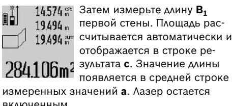
Затем измерьте длину **B<sub>1</sub>** первой стены. Площадь расчета считывается автоматически и отображается в строке результата **c**. Значение длины **B<sub>1</sub>** появляется в средней строке измеренных значений **a**. Лазер остается включенным.
