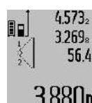
По окончании измерения результат для искомого отрезка **«X»** отображается в строке результата **c**. Значения измерения для отрезков **«1»**, **«2»** и угла **«α»** отображаются в строках измеренных значений **a**.
