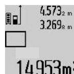
По окончании второго измерения значение площади автоматически рассчитывается и высвечивается в строке результата **c**. Отдельные измеренные значения отображаются в строках измеренных значений **a**.
