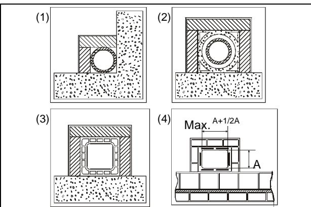
(1) Дымоход из стали AISI 316 с двойной изолированной камерой из материала устойчивого к температуре до 400°C. **Эффективность 100% отличная.**
