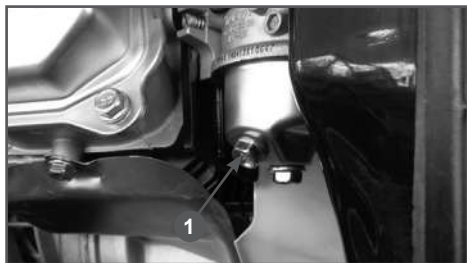
Рис. 21 Слив топлива из карбюратора
