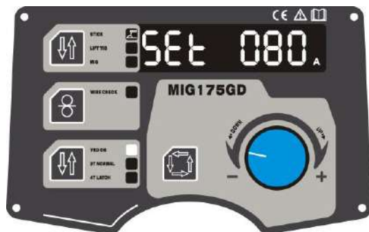
Рис 2: режим STICK, дисплей, VRD активен
