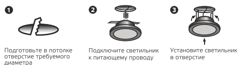
Рис. 2. Схема подключения светодиодного светильника к электросети 220 В
